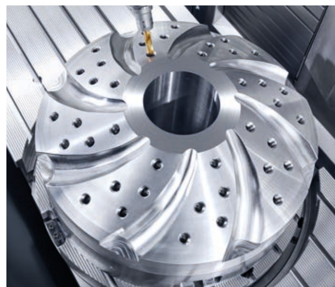
Zintegrowany stół obrotowy sterowany NC do obróbki 5-osiowej i frezo-toczenia.
