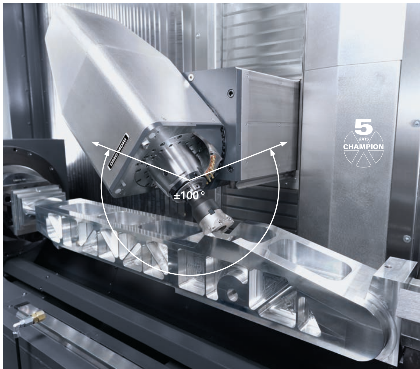
5-osiowa obróbka trawersu na DMF 26017.
