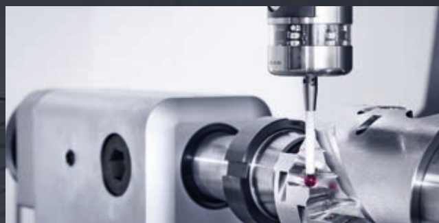
OPCJA // stół obrotowy NC do efektywnej obróbki z osią A (również symultanicznej)
