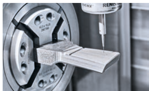
5-osiowa obróbka symultaniczna części narzędzia na NTX 1000.
