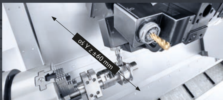
OPCJA // oś Y z drogą przesuwu \pm 60 mm, obróbka frezarska na tokarkach
