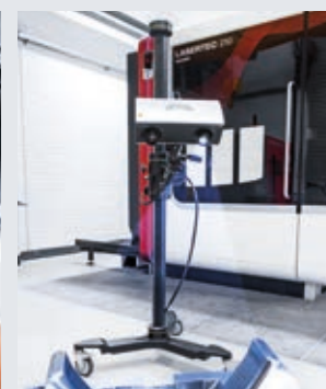
Pomiar geometrii narzędzia za pomocą skanera 3D.
