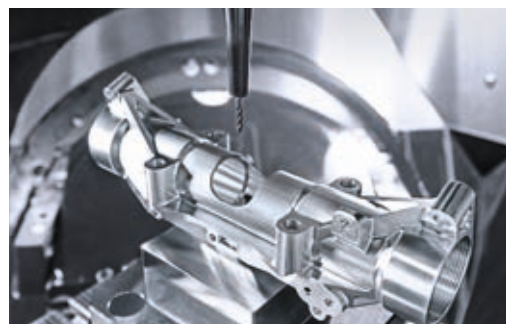
5-osiowa obróbka na DMU 60 eVo.
